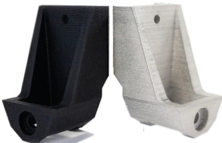
Soporte de polea fabricado con AMCELL® utilizando PLA y acero inoxidable 316L sin acabado superficial.
